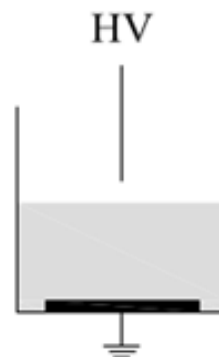
Слика 5: Електродна конфигурација за тип пражњења у гасној фази изнад течности
